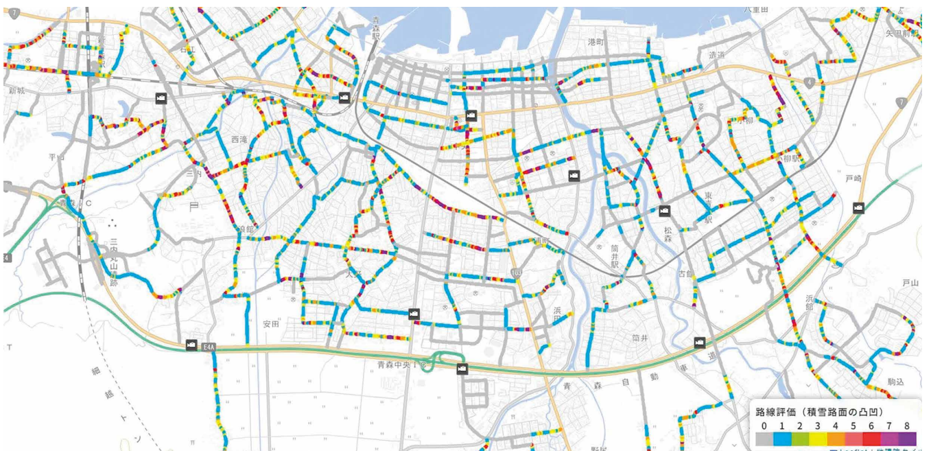
除排雪判断支援システムによる積雪路面における路線評価
