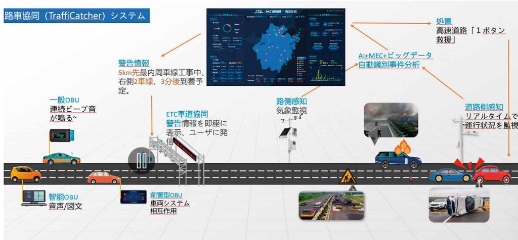
情報はETCガントリーを通じて音声や映像をETC車載器に送信される。このようにして旅行者によりタイムリーな交通情報を提供し、道路網全体の安全性を向上する。
